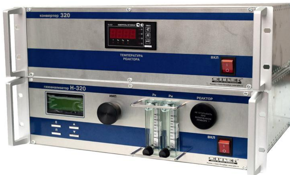
Фото 1 - Внешний вид газоанализатора мод. Н-320
